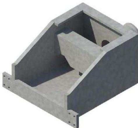
**Figura 15: Perspectiva de entrada do dissipador do tipo impacto, modelo *Bradley-Peterka*.**
